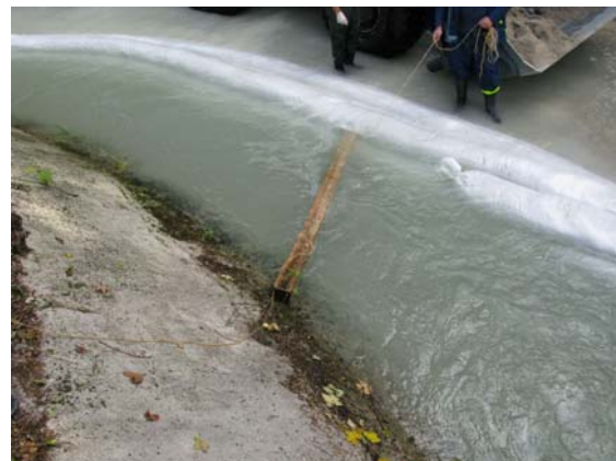
Abb. 16: Stabile 7er Barriere bei Kantholzverkeilung und Überströmung.
