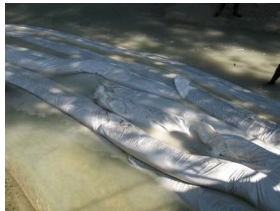
Abb. 22: Überlappungsbereich nach Versagen und Abstellen des Abflusses.
