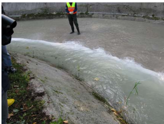
Abb. 7: Überströmte 3er Barriere in der Kurve vor Eintreten des Schadens.
