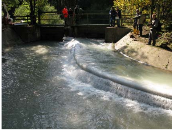
Abb. 19: Überströmte 10er Barriere unmittelbar vor Versagensbeginn.
