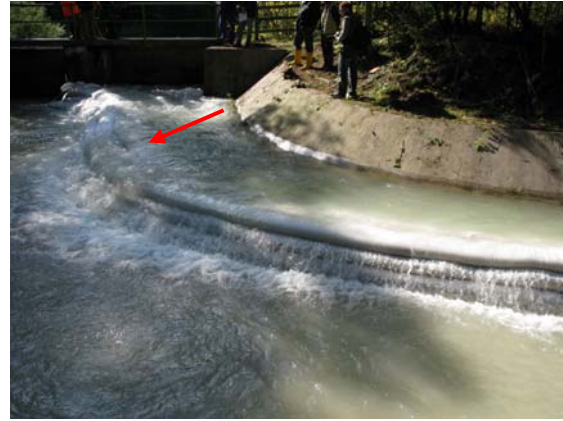
Abb. 20: 10er Barriere bei Versagensbeginn.
