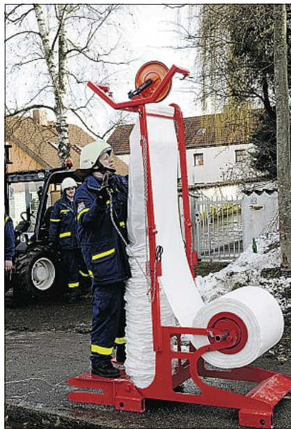
Ein Mann genügt, um die Rohre mit Folie von einer 750-Meter zu bestücken. – Drei Mann braucht man für das Verlegen: Einer fährt, einer weist ein, der andere schaut, dass die Schläuche auch richtig in Pyramidenbauweise liegen.
